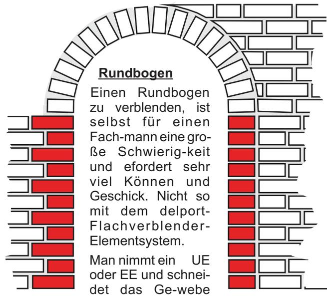
von der Knicklinie an, an der Seite die auf der Wand liegen soll, durch. Jetzt drückt man zuerst die zusammenhängende Hälfte in der Leibung in das Kleberbett und legt die andere Hälfte nach vorne um. Die Verblender legen sich automatisch in gleichmäßigem Abstand in die richtige Richtung. Auch die Fugen haben automatisch den richtigen Abstand und laufen nach außen gleichmäßig konisch auseinander.
